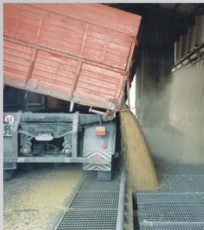
Ribaltamento cereali in fossa
